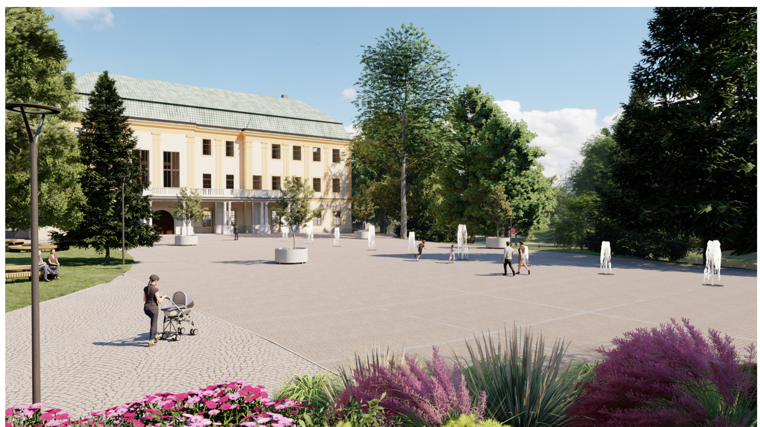
Prostor východně od zámku získá novou tvář ve formě velké dlažďené plochy s multifunkčním využitím. Centrální osou plochy budou vedeny trysky zapuštěné fontány, které osvěží a oživi prostor v letních měsících, v případě potřeby jsou trysky pochozí. Velkoformátové květináče oživi prostor s mobilní zelení. Nabízi se zde také místo pro umístění mobilní tribuny s půdorysnými rozměry 6x8m přímo před průčelím zámku, který by tak tvořil také její zázemí.
